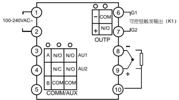
注：本仪表线性电压不支持0~5V及1~5V输入，如有需要应外接精密电阻分压后将信号转换为0-500mV或100-500mV输入。4~20mA线性电流输入用25欧电阻变为100~500mV，然后从9、8端输入。3、4、5端安装S或S4通讯接口模块时用于通讯（COMM），安装L2继电器时用于AU1报警输出。安装L5双继电器输出模块，并将bAud参数设置为0，可用于AU1及AU2报警输出（只具备常开输出端）。
