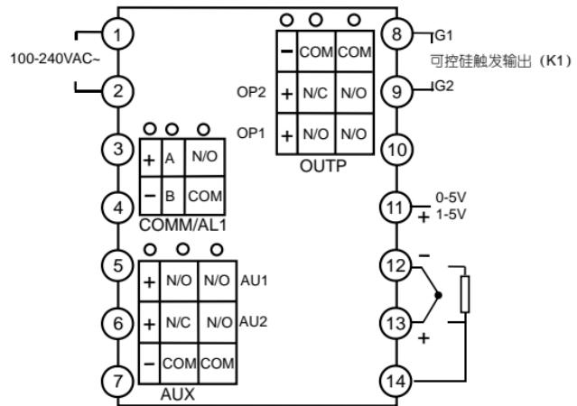
注：线性电压量程在500mV以下的由13、12端输入，0~5V及1~5V的信号由11、12端输入。4~20mA线性电流输入可用250欧电阻变为1~5V电压信号，然后从11、12端输入。COMM位置安装S或S4通讯接口模块时用于通讯，安装继电器/无触点开关/SSR电压输出模块时用于AL1报警输出。
