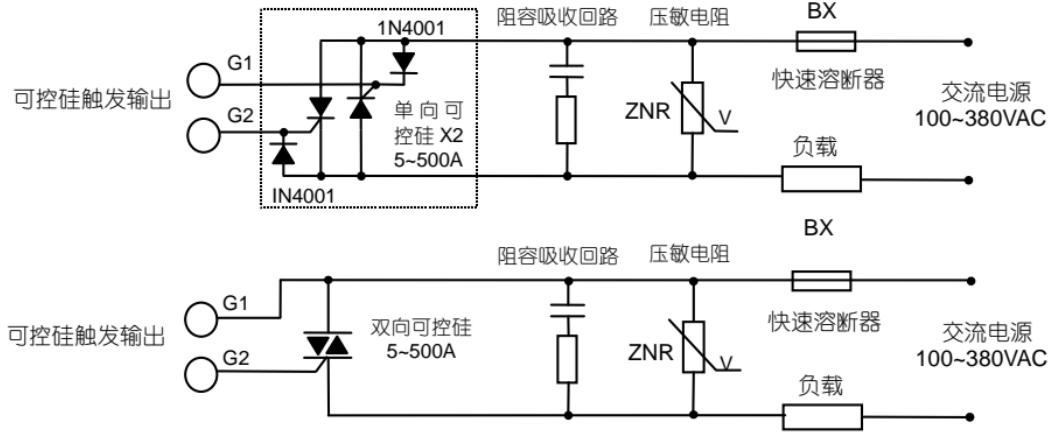
注：1、根据负载的电压及电流大小选择压敏电阻以保护可控硅，负载为感性或采用移相触发时，必须加阻容吸收。2、推荐使用可控硅功率模块，一个功率模块内部包含2个单向可控硅，如图中虚线部分；3、K1/K3/K5触发模块具备“烧不坏”功能，使用方便可靠。4、采用K5型移相触发输出模块时，但交流电源范围缩小为220~380VAC，且电源频率必须为50Hz。
